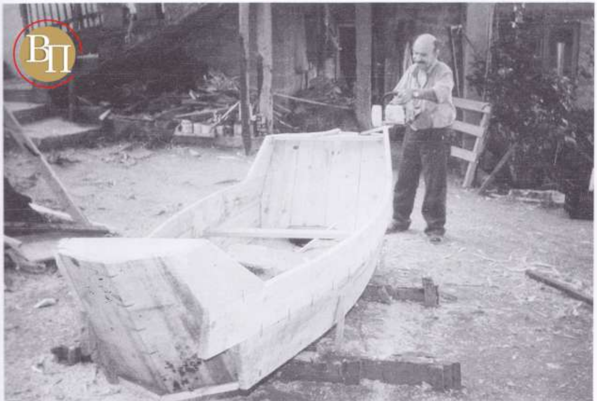
Η μπροστινή πρύμη με τους δυο λαμπάδες και η πίσω με τα τέσσερα σανίδια.
