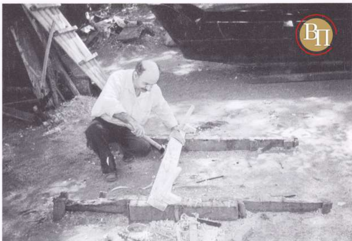
Το τροχαντήρι με τους σκαρμούς στο τεζάχι.
