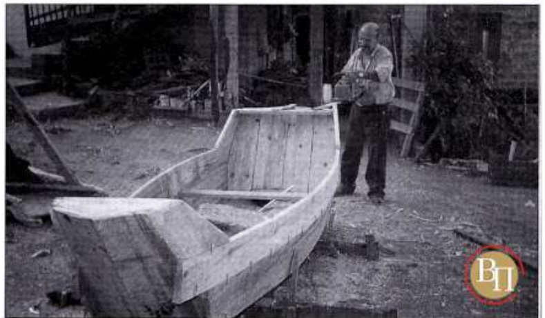
Παρατιές, περβάζια και πρύμες. Διακρίνονται οι δυο λαμπάδες της μπροστινής πρύμης, οι λαμπάδες της πλαινιας πρύμης με δυο σανίδια ο καθένας, τα κανάτια και τα άνω οτοράκια.
