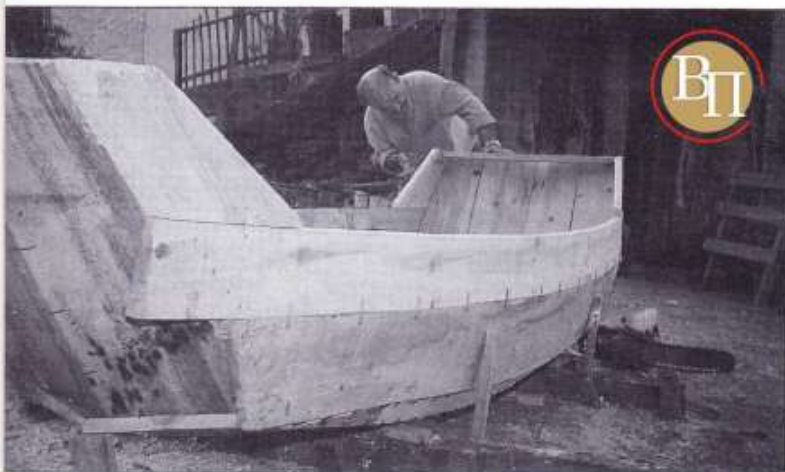
Η μπροστινή πρύμη με τους δυο λαμπάδες και η πσιινή με τα τέσσερα σανίδια. The front stern with the two lambades (planks) and the back stern with the four planks.
